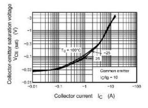
Fig. 8.3 V<sub>CE(sat)</sub> - I<sub>C</sub>
