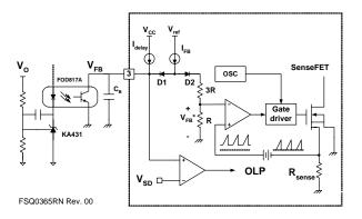
Figure 21. Pulse-Width-Modulation (PWM) Circuit
