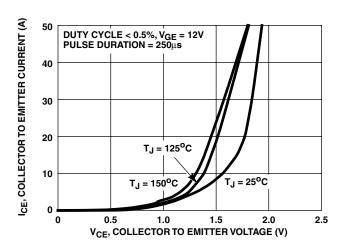
FIGURE 5. COLLECTOR TO EMITTER ON-STATE VOLTAGE
