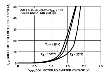
FIGURE 6. COLLECTOR TO EMITTER ON-STATE VOLTAGE
