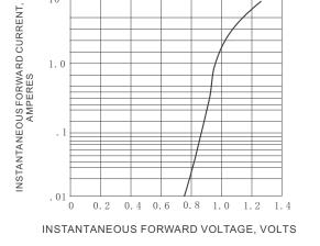
Fig.2 TYPICAL INSTANTANEOUS FORWARD CHARACTERISTICS
