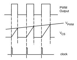
Figure 31. Current-Mode Timing Diagram
