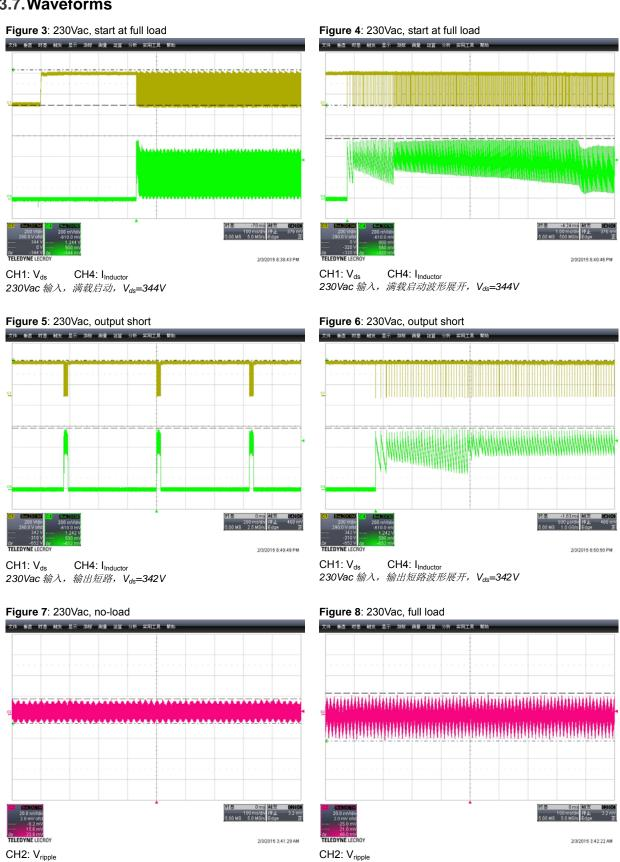
230Vac 输入,空载,V<sub>ripple</sub> =23.8mV
