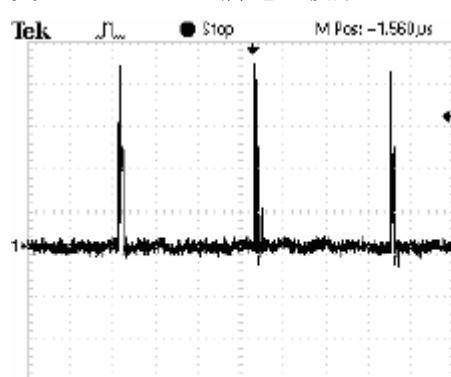
交流 110VAC, DRAIN 脚电流波形
