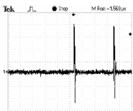
交流 110VAC, DRAIN 脚电流波形
